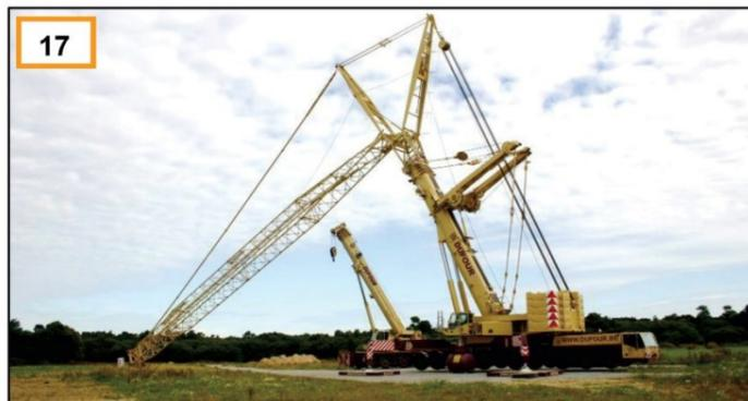
17 Assemblage des éléments de la grue
